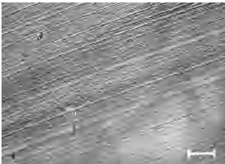
Abbildung 8. HWM-Zellwolle Polyflox ® . Bündelartige Längsriffelung. [Oberflächenabdruck Pd + C. Vergr. 10.000 ×]
