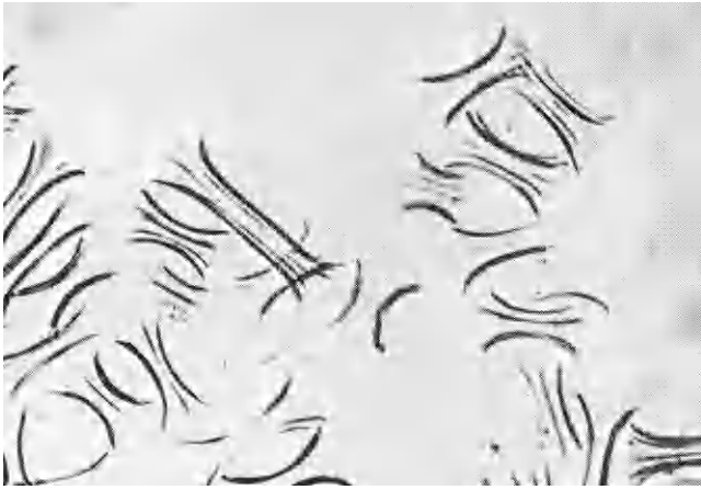
Abbildung 9. Quellung in EWNN-Lösung (Normalzellwolle)
