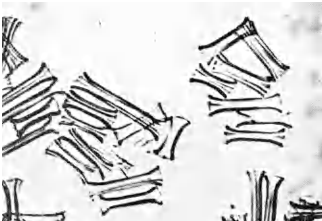
Abbildung 8. Quellung in EWNN-Lösung (Normalzellwolle)
